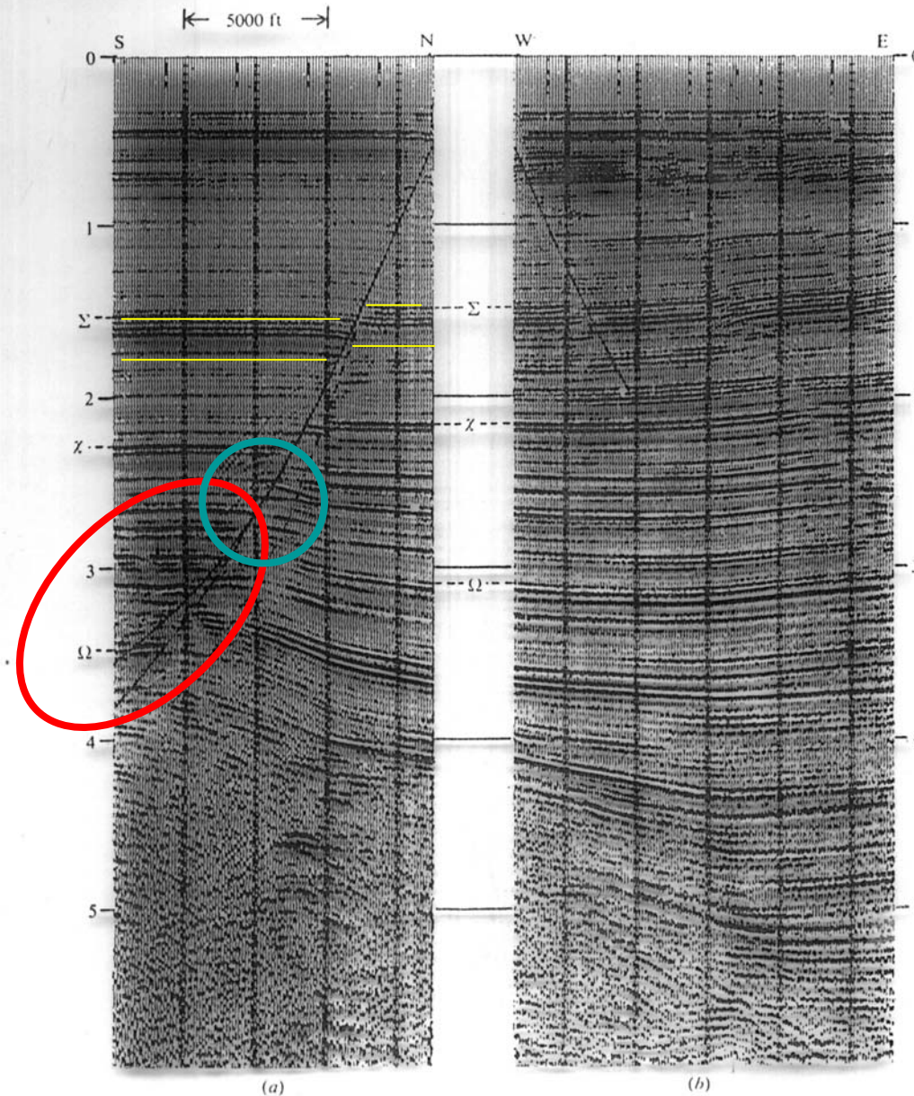
Figura 9.22. Secciones sísmicas no migradas intersecantes que muestran fallamiento. (Cortesía de GSI.) a) Sección N-S; b) Sección E-O.
