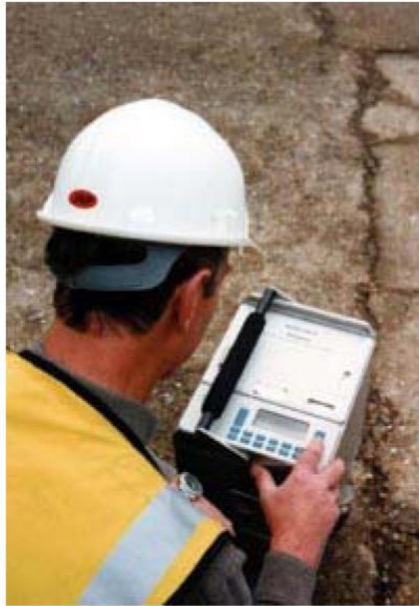
Figura III.12: Foto de un gravímetro Scintrex Autograv CG-3.
